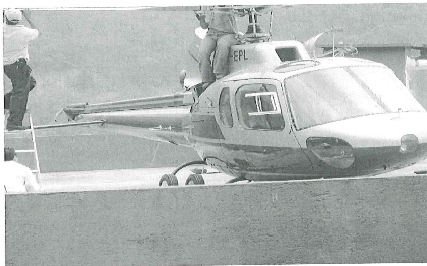
Vista general de la forma en que quedo el helicóptero después de perder el rotor de cola.
